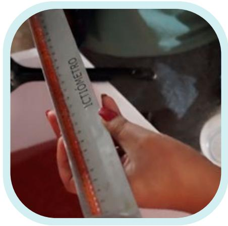
Colocar las ovas, sin presionar, en la canaleta de la regla en “V” de 12 pulgadas (30,5 cm).
