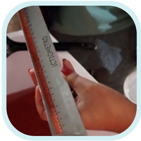
Colocar las ovas, sin presionar, en la canalleta de la regla en “V” de 12 pulgadas (30,5 cm).
